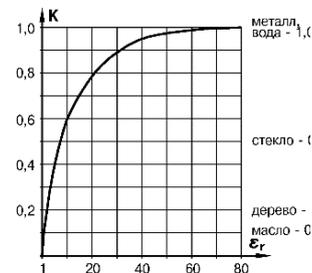
Зависимость поправочного коэффициента от диэлектрической проницаемости материала ( $\epsilon_r$ ) объекта:
