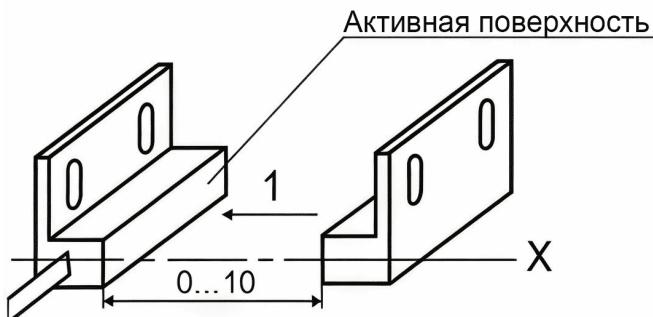
При нахождении датчика в зоне действия магнитного поля инициатора контакты геркона размыкаются и остаются в разомкнутом состоянии до тех пор, пока инициатор не выйдет из чувствительной зоны датчика.
