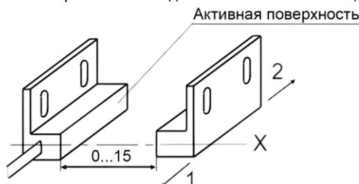
Правильный алгоритм работы обеспечивается при движении инициатора в направлении 1 и 2, относительно активной поверхности датчика.
